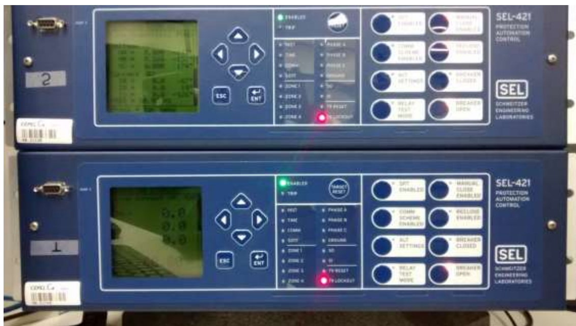
Figura 15 – Unidade PMU e GPS adquiridos por meio do Projeto META para o LABPMU (Fornecedor: Schweitzer Engineering Laboratories do Brasil Ltda.).
